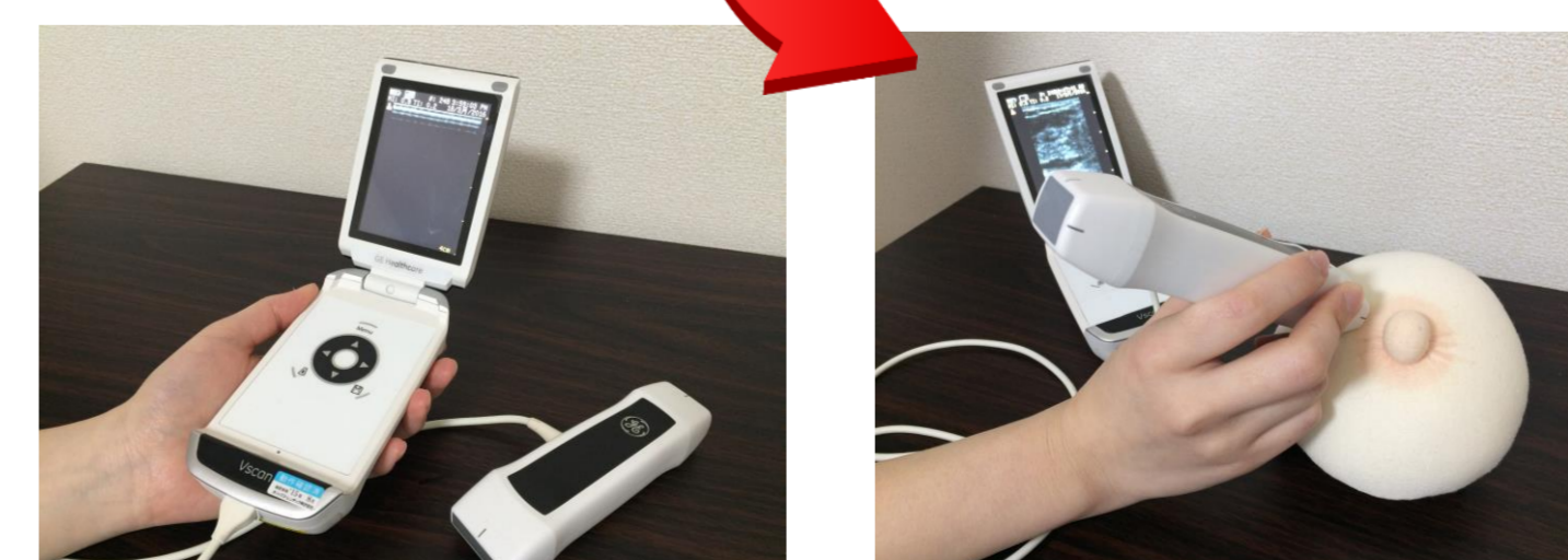
Vscan Dual Probe/GEヘルスケア・ジャパン ・重さ: 436g ・ディスプレイ: 3.5インチ ・リニア探触子(最大周波数8.0MHz)使用
